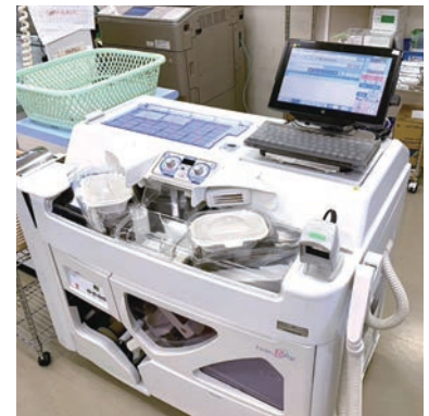
散薬鑑査システムと全自動散薬分包機。
